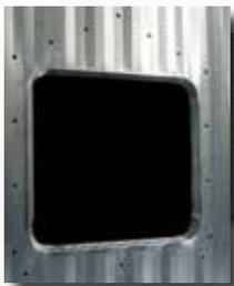
Sukup laminas de techo pueden ser pre-perforadas para 18" ventiladores de techo, el pre-perforado produce un extra dobles alto de (1 1/8 ") labio que funciona como una barrera evitando que la humedad se filtre en el contenedor a través de la abertura.
