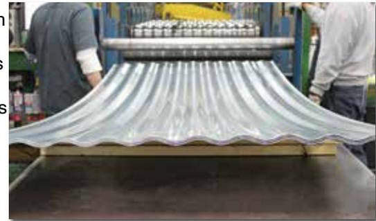
Las laminas de las paredes laterales comienzan como bobinas de acero americano plana, nuestras máquinas forman las ondulaciones, perfora los orificios por los tornillos y crea la curva en las hojas, todo para nuestras estrechas tolerancias. Cada componente importante de un Silo Sukup comienza el acero en blanco que nuestros empleados utilizan para crear un producto de alta calidad.
